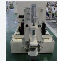
ちょこっとバックで台車と自動ピンを自動 連結が可能
