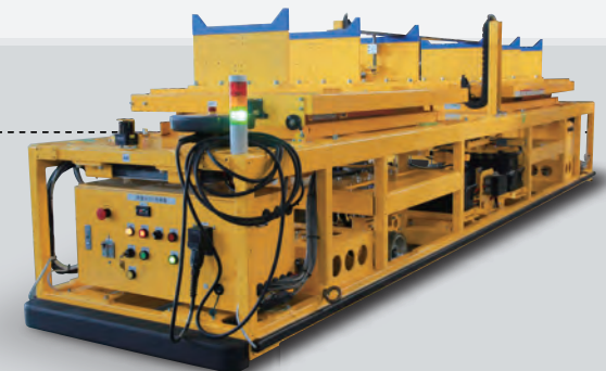
(例) 1t 用リフター型 AGV: 上昇幅 500mm
