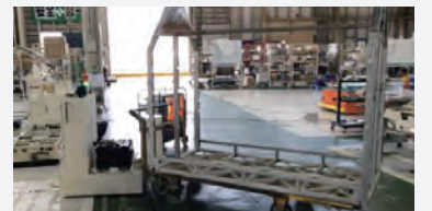
ちょこっとバックで台車と自動ピンを自動 連結が可能
