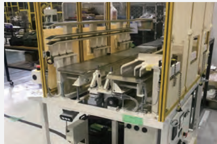
電動シリンダーで押し出すプッシャータイプ。
