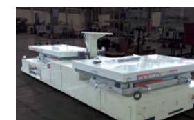
(例) 1t 用リフター型 AGV: 上昇幅 500mm
